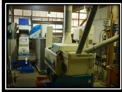
刈り取った稲を作業所の乾燥機に運び、貯蔵に適した水分量に一晩ゆっくりかけて乾燥させます。稲摺り機という機械にかけて籾殻（もみがら）を取り除き、玄米にして各種選別機に通します。異物や未熟な粒・虫食いの粒を選別、綺麗な玄米だけを残します。この工程を、乾燥調製と呼びますが、埃と轟音でまるで工場のように。でもこれも、確かに米作りの一環
